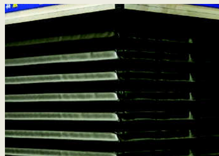
Skyddsbälg monterad på ett lyftbord.
